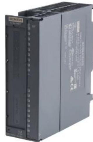
SIMATIC S7-300, Sortie analogique SM 332, séparation galvanique voie par voie, 4 sorties analogiques, résolution 16 bits, 0-10V, 1-5V, +/-10 V, +/-20 mA, 0/4-20mA
