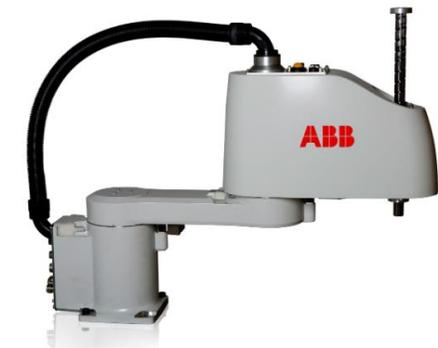
Robots SCARA 3 ou 4 axes
