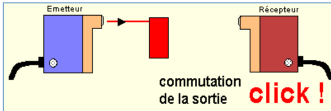
Principe des cellules photo-électriques de type barrage
