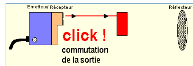
Principe des cellules photo-électriques de type reflex
