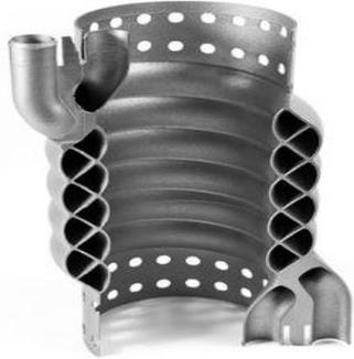
**La fabrication additive**, plus connue sous le nom d'**impression 3D**, est un processus de fabrication qui transforme un modèle 3D en un objet physique, en assemblant des couches successives d'un même matériau.
