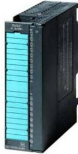
SIMATIC S7-300, entrée analogique SM 331, à séparation galvanique, 8 entrées analogiques, résolution 9/12/14 bits, U/I/thermocouple/résistance, alarme, diagnostic, 1x 20 pôles débroschage/enfichage avec bus interne actif
